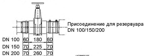
Рис. 39: Задвижки при типоразмерах UZ150, UZ300
